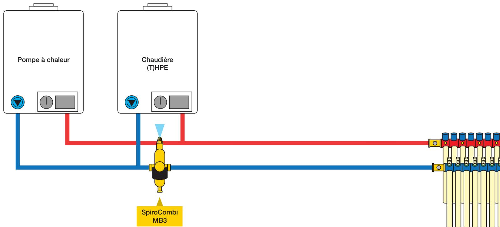
Schéma : circuit avec PAC hybride et SpiroCombi MB3
